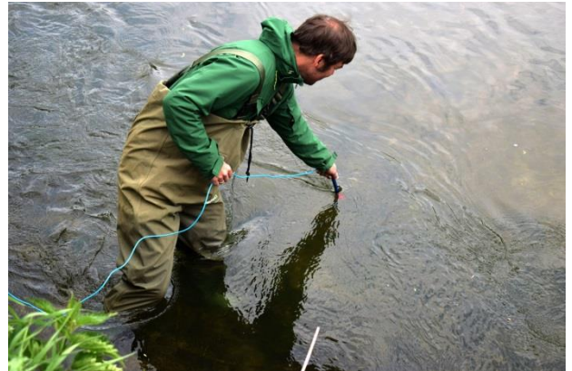
Abb. 3-2: Messung der Fließgeschwindigkeit mit einem Messflügel.
