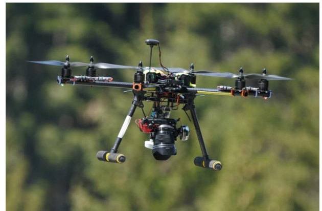
Abb. 3-4: Drohne im Einsatz zur Dokumentation von Gewässerstrukturen.
