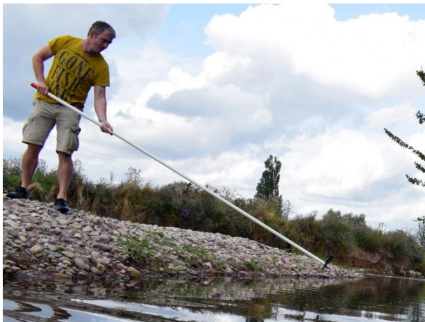
Abb. 3-8: Einfache Sondenkamera (action-cam) auf 3 m-Stab montiert.
