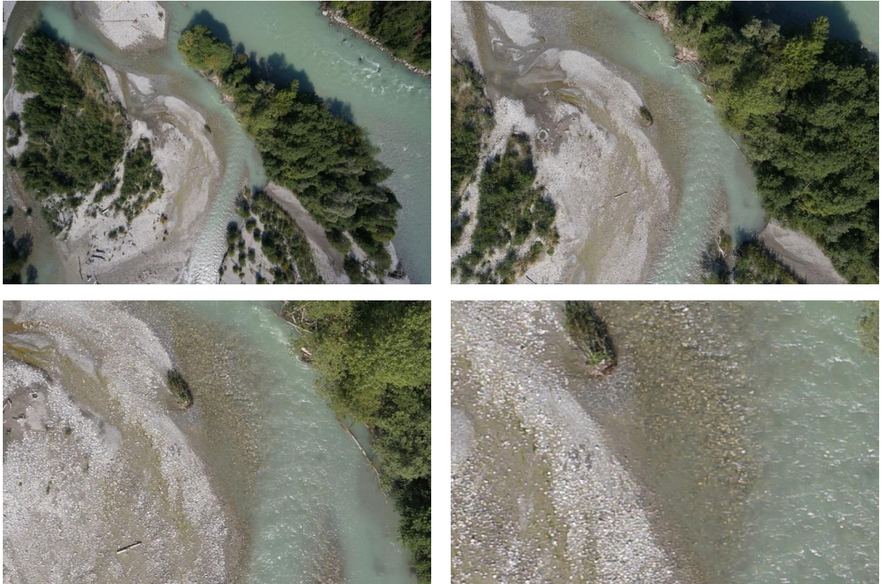
Abb. 3-5: Aufnahme von Gewässerstrukturen mit einer Drohne aus 60 m Flughöhe. Originalaufnahme (oben links) und die Zoomebenen zwei- (oben rechts), vier- (unten links) und achtfach (unten rechts). Mit heute gängiger Leistungsfähigkeit der Kameraeinheiten lassen sich von oben sichtbare Strukturen problemlos im Dezimeterbereich auflösen (Quelle: HYDRA, Dr. John Hesselschwerdt).
