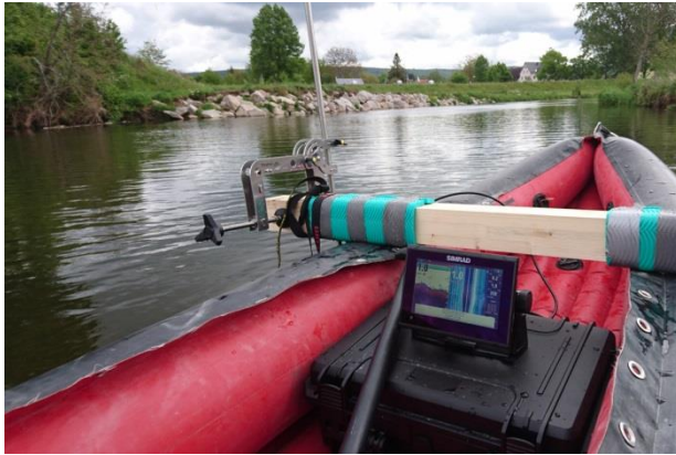
Abb. 3-6: Mobile Echoloteinheit der mittleren Preisklasse zur Aufnahme von Wassertiefen.
